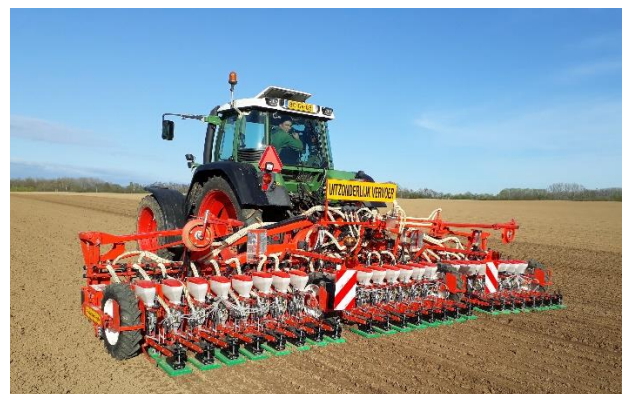
Afbeelding: nieuw zaaimachine van Kramer met ski-voeten
